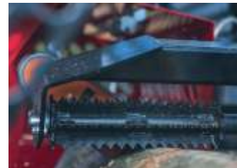
ozubený p ítla ný válec p ed lištou
